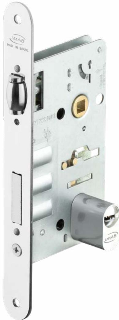
A Fechadura IMAB 4700 oferece segurança, funcionalidade mecânica, qualidade e durabilidade. Conta com trinco rolete em latão reforçado, chapa testa e contratesta em latão, além de lingueta em zamac reforçado. As estruturas e molas são super-reforçadas, com sistema antidesgaste, caixa em aço e componentes superdimensionados com tratamento individual anticorrosão. São compatíveis com a linha de Puxadores e Guarnições IMAB e disponível em 2 opções de cilindros:
