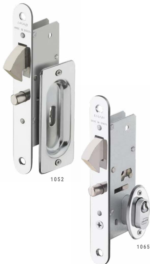
As fechaduras IMAB 1052 / 1065 oferecem segurança, funcionalidade mecânica, qualidade, robustez e alta durabilidade. Ideais para perfis estreitos. Caixa em aço zincado, componentes internos em aço e zamac protegidos contra corrosão. Incluem chapa testa e contratesta em latão ou aço inox. Lingueta e pino guia em zamac níquelado. Compatível com as guarnições IMAB. Fechadura 1065 compatível com 2 opções de cilindros:
