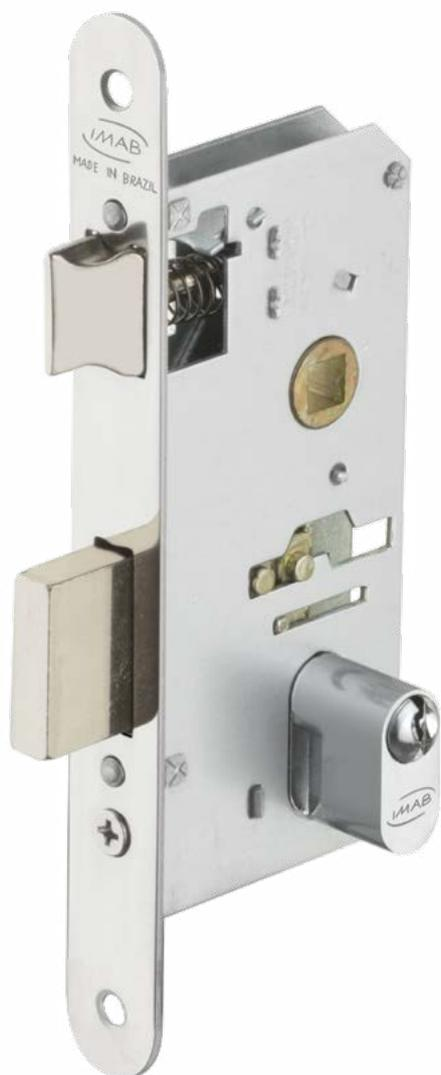
A Fechadura IMAB 1400 oferece segurança, funcionalidade mecânica, qualidade, robustez e alta durabilidade. Estruturas tipo monobloco reforçadas e caixa em aço zincado, componentes superdimensionados com tratamento individual anticorrosão, molas super-reforçadas e sistema antidesgaste. Incluem chapa testa, falsa testa, contratesta e parafusos em aço inox, trinco e lingueta em zamac. Compatíveis com a linha de Maçanetas e Guarnições IMAB e 2 opções de cilindros:
