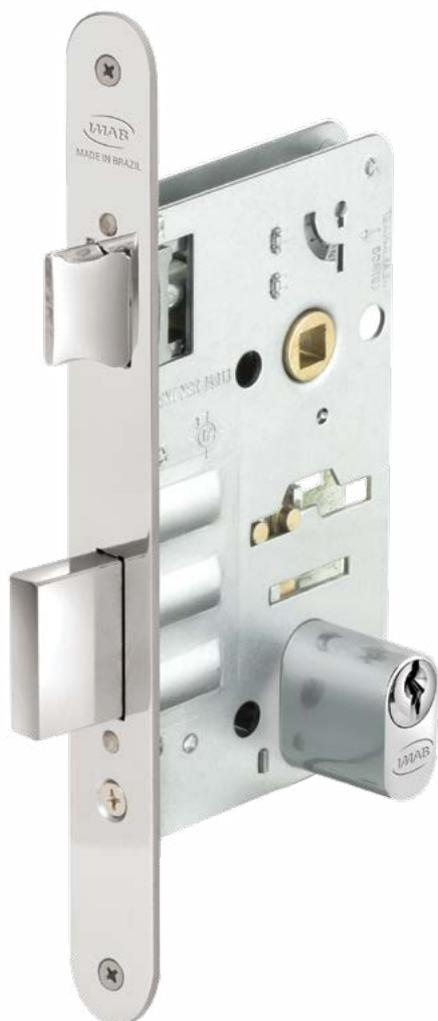
As Fechaduras IMAB 4000 oferecem segurança, funcionalidade mecânica, qualidade e resistência. Contam com chapa testa e contratesta em latão, lingueta e trinco reforçados em zamac. Possuem estruturas e molas super-reforçadas e sistema antidesgaste. Caixa em aço zincado e componentes superdimensionados com tratamento individual anticorrosão. São compatíveis com a linha de Maçanetas e Guarnições IMAB e disponíveis em 2 opções de cilindros:
